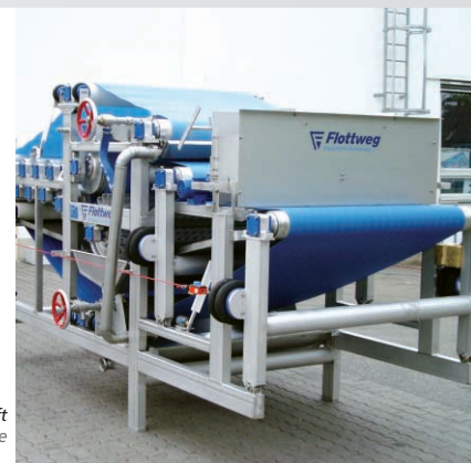
Doppelsiebbandpresse für Fruchtsaft Double belt press for fruit juice
