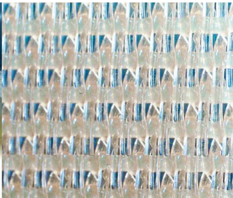
PPS 5099 mesh for high chemical or thermal load PPS-5099-Gewebe für hohe chemische oder thermische Belastung
